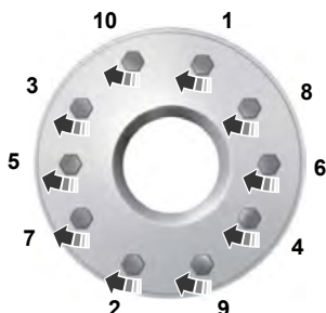
10-lug nut torque sequence
